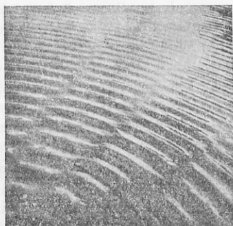
Σχ. 339 καὶ 340. Τὰ σημεία, εἰς τὰ ὅποια τὰ δύο κύματα ἀλληλοαναίρουνται, κεῖνται ἐπὶ ὑπερβολῶν. [Κατὰ Grimsch: Lehrbuch der Physik].
