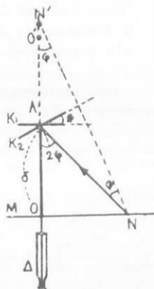
Σχ. 156. Μέτρησης μικρῶν γωνιῶν.
