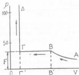
Σχ. 63. Ἰσόθερμος τοῦ  $\text{CO}_2$  διὰ τὴν θερμοκρασίαν  $13^{\circ}\text{C}$ . (Ἡ πίεσις  $p$  εἰς at.)
