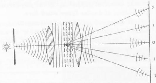
Σχ. 286. Σχηματικὴ διάταξις φασματογράφου.
