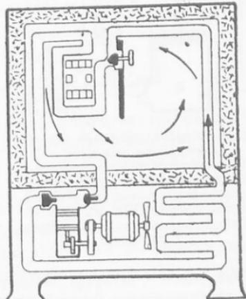
Σχ. 67. Τομὴ ἡλεκτρικοῦ ψυγείου. Διὰ τοῦ κινητήρος λειτουργεῖ ἀντλία, τὸ δὲ αέριον κυκλοφορεῖ ἐντὸς κλειστοῦ συστήματος. Τὰ βέλη δεικνύουν τὰ σχηματιζόμενα ρεύματα τοῦ αέρος.
