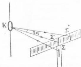
Σχ. 170. Μέτρησις μικρῶν γωνιῶν.
