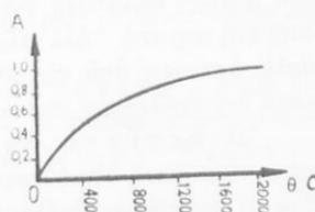
Σχ. 98. Μεταβολὴ τῆς θεωρητικῆς ἀποδόσεως συναρτᾶται τῆς θερμοκρασίας τῆς θερμῆς πηγῆς. (Ὡς θερμοκρασία τῆς ψυχρᾶς πηγῆς ἐλήφθη  $27^{\circ} \text{C}$ .)
