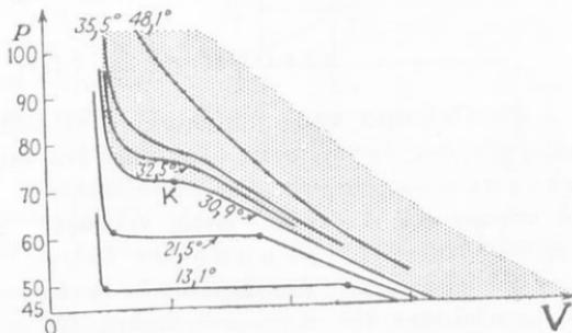
Σχ. 64. Τὸ δίκτυον τῶν ἰσοθέρων τοῦ διοξειδίου τοῦ ἀνθράκος. (Κρίσιμος θερμοκρασία  $30,9^{\circ}\text{C}$ , ἡ περίπτου  $31^{\circ}\text{C}$ .)
