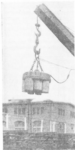
Σχ. 337. Γερανὸς χρησιμοποιῶν ἠλεκτρομαγνήτην διὰ τὴν ἀνύψωσιν σιδηρῶν ἀντικειμένων.
