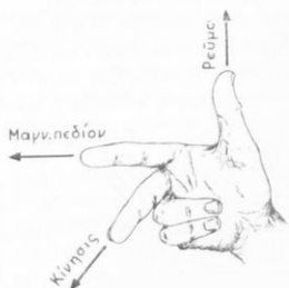
Σχ. 339. Μνημονικὸς κανὼν τῆς δεξιᾶς χειρὸς, δείκνυν τὴν διεύθυνσιν τῆς μετατοπίσεως τοῦ ἀγωγοῦ.
