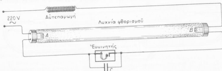
Σχ. 412. Συνδεσμολογία λυχνίας φθορισμοῦ.
