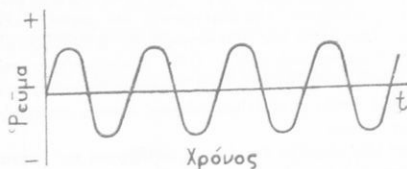
Σχ. 442. Τὸ πλάτος εἰς τὰς συντηρουμένας ταλαντώσεις παραμένει σταθερόν.
