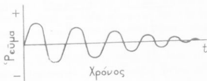
Σχ. 444. Τὸ πλάτος εἰς τὴν ἀποσβεννύμενην ταλάντωσιν μειοῦται μετὰ τὴν πάροδον τοῦ χρόνου καὶ τέλος μηδενίζεται (παῖσις τῶν ταλαντώσεων).
