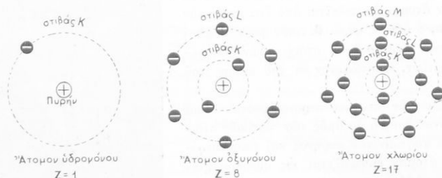
Σχ. 485. Εἰς ἐκάστην στιβάδα, δι' οὐδέτερον ἄτομον, ὁ ἐπιτρεπόμενος ἀριθμὸς ἠλεκτρονίων εἶναι καθωρισμένος.
