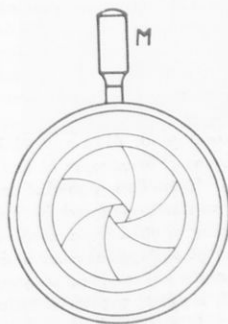
Σχ. 161. Διάφραγμα φωτογραφικῆς μηχανῆς (Ἰρις). Διὰ καταλλήλου μετακινήσεως τοῦ μοχλοῦ Μ αὐξάνομεν ἢ ἐλαττοῦμεν τὸ εὖρος τοῦ διαφράγματος.
