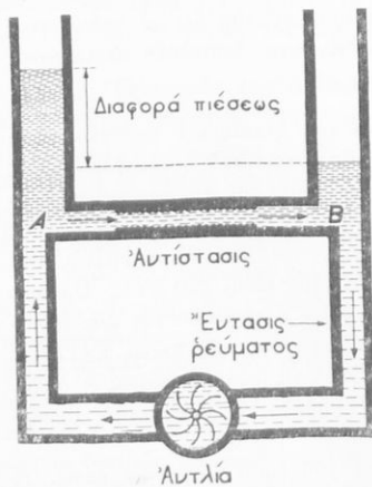
Σχ. 220. Μηχανικὸν ἀνάλογον πρὸς κατανόησιν τῆς γενέσεως τοῦ ἡλεκτρικοῦ ρεύματος.
