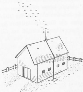
Σχ. 482. Ἀλεξικέραυνον ἐγκατεστημένον ἐπὶ οἰκίσκου.
