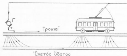
Σχ. 279. Ἡλεκτρολυτικὴ διάβρωση μεταλλικοῦ ὀχητοῦ ὕδατος.
