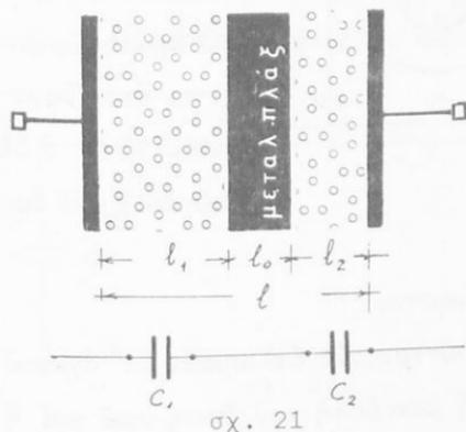
Ἐπὶ τῶν παρεϊῶν τῆς μεταλλικῆς πλακῶς ἐπάγονται φορτία καί οὕτω τὸ σύστημα ἰσοδυναμεῖ πρὸς σύνδεσιν δύο πυκνωτῶν μέ μήκη  $l_1$  καί  $l_2$  ἐν σειρᾷ.
