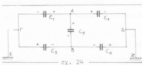
Συνδέομεν ἐν συνεχείᾳ εἰς τὰ Α καί Β τόν  $C_5 = 3 \mu\text{F}$  φορτισμένον μέ  $Q_5 = 120 \mu\text{C}$ .
