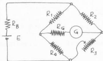
β) Ἐάν  $E=1,5\text{V}$ ,  $R_1=40\Omega$ ,  $R_2=100\Omega$ ,  $R_4=400\Omega$ ,  $R_G=250\Omega$  καί  $R_B$  εἶναι ἀμελητέα, νά εύρεθῆ ἡ τιμή της  $R_3$  διά τήν ὁποίαν ἡ γέφυρα ἰσορ-
