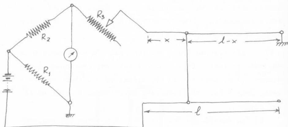
ναι 40  $\Omega/\text{km}$ . Εὑρετε τὴν ἀπόστασιν  $x$  τοῦ βραχυκυκλώματος ἂν στὴν θέση ἰσορροπίας ἡ  $R_3$  εἶναι 440  $\Omega$ .
