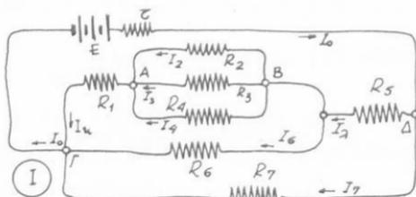
$$R_i = \frac{R_2 R_3 R_4}{R_2 R_3 + R_3 R_4 + R_2 R_4} = 3\Omega$$
