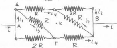
36 Έκαστον τών τετραγώνων του κυκλώματος έχει πλευράν μήκους 40 cm και είναι εκ του ίδιου ίσοπαχους σύρματος. Έάν τό ρεύμα εισέρχεται και έξέρχεται ως είς τό σχήμα υπολογίσατε την όλικη αντίστασιν του κυκλώματος σε ίσοδύναμον μήκος εκ του ίδιου σύρματος.
