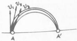
★ Τὸ ἠλεκτρόνιον εἰσέρχεται εἰς τὸ πεδίου με ταχύτητα  $v_0$  τῆς ὁποίας ἡ διεύθυνσιν σχηματίζει τυχούσαν γωνίαν  $\phi$  με τὴν διεύθυνσιν τοῦ πεδίου.
