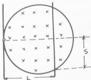
78 Πηνίον μήκους  $l$  ( $l = 1,20\text{m}$ ) καί τομῆς  $S$  ( $S = 50,3 \text{ cm}^2$ ) φέρει  $N$  ( $N = 750$ ) σπείρας. Μικρόν πηνίον, τομῆς  $\sigma$  ( $\sigma = 4,91 \text{ cm}^2$ ) μέ  $n$  ( $n = 30$ ) σπείρας, τοποθετεῖται ὁμοαξονικῶς εἰς τό μέσον του πηνίου. Ὑπολογίσατε τήν μέσην ΗΕΔ τήν ἐπαγομένην εἰς τό μικρόν πηνίον, ὅταν ἡ φορά του ρεύματος, ἐντάσεως  $i$  ( $i = 4\text{A}$ ), του διαρρέοντος τό πρώτον πηνίον, ἀναστρέφεται ἐντός χρόνου  $dt$  ( $dt = 0,2 \text{ sec}$ ).
