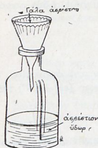
Σχ. 94. Παρασκευὴ ἀσβεστίου ὕδατος.
