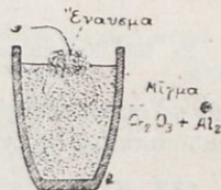
Σχ. 102 Ἀναγωγή του οξειδίου του χρωμίου.
