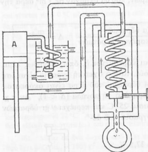
Σχ.143. Σχηματική παράσταση τής μηχανής του Linde για τήν υδροποίηση του άερα. (Α συμπιεστής, Β θάλαμος προψύξεως, Γ θάλαμος έκτονώσεως, Δ σωλήνας πού φέρνει τόν πιεσμένο ψυχρό άερα, Ζ θάλαμος υδροποίησης του άερα).
