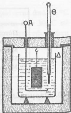
Σχ. 133. Θερμιδόμετρο με νερό ( $\Theta$  θερμόμετρο.  $A$  όργανο για το ανάκατεμα).
