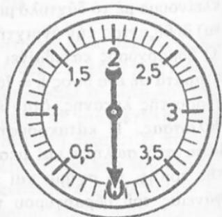
Σχ. 109. Μεταλλικό βαρόμετρο γιά τή μέτρηση ὕψους ἀπό 0 ὄς 4 km.
