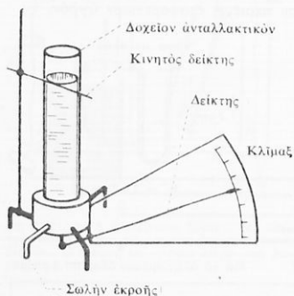
Σχ. 1. Συσκευή δια τὴν μελέτην τῆς δυνάμεως, ἣ ὁποία ἀσκεῖται εἰς τὸν πυθμένα τοῦ δοχείου.
