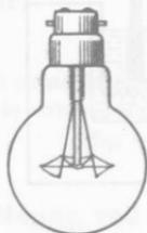
Σχ. 40. Ήλεκτρικός λαμπτήρας πυρακτώσεως.
