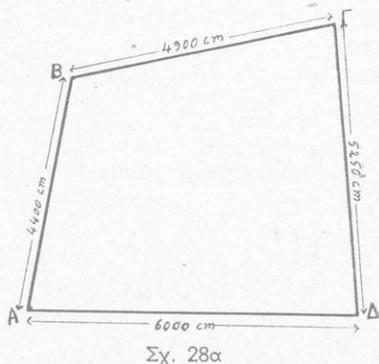
$$(AB) \simeq 4400 \pm \frac{1}{2} \text{ cm}, (B\Gamma) \simeq 4900 \simeq \frac{1}{2} \text{ cm}$$
