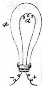
τοῦ Ἐδισσων σύγκειται ἐξ υαλίνης φιάλης Φ σχήματος ἀπιδίου (σχ 52), ἣτις εἶναι ἀπολύτως κενὴ ἀέρος. Τὸ πῶμα τῆς φιάλης διαπερῶσι δύο σύρματα ἐκ λευκοχρύσου· εἰς τὰ ἐντὸς τῆς φιάλης ἄκρα τῶν δύο συρμάτων εἶναι δεμένα τὰ δύο ἄκρα νήματος α, τὸ ὁποῖον κατασκευάζεται δι' ἀπανθροακώσεως τῶν ἰσῶν ἰνδικοῦ καλάμου.
