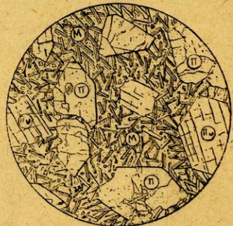
Σχ. 32.—Βασάλτης ὁρῶμενος διὰ τοῦ μικροσκοπίου M Μικρόλιθοι, Πυ Πυροξένον.
