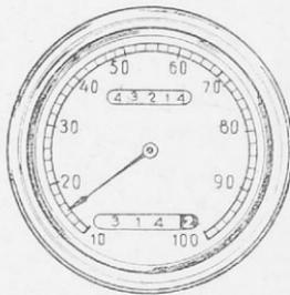
Σχ. 51. χιλιομετρικὸς μετρητὴς αὐτοκινήτου
