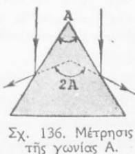
Σχ. 136. Μέτρησις τῆς γωνίας  $A$ .
