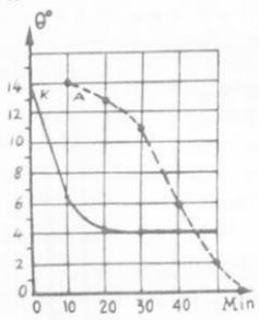
Σχ. 19. Μεταβολή της θερμοκρασίας τῶν δύο θερμόμετρων τῆς συσκευῆς τοῦ Hope (Α ἀνώτερον, Κ κατώτερον θερμόμετρον).
