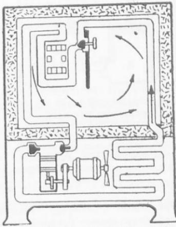
Σχ. 67. Τομὴ ἡλεκτρικοῦ ψυγείου. Διὰ τοῦ κινητῆρος λειτουργεῖ ἀντλία, τὸ δὲ ἀέριον κυκλοφορεῖ ἐντὸς κλειστοῦ συστήματος. Τὰ βέλη δεικύνουν τὰ σχηματιζόμενα ρεύματα τοῦ ἀέρου.
