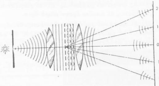
Σχ. 286. Σχηματικὴ διάταξις φασματογράφου.
