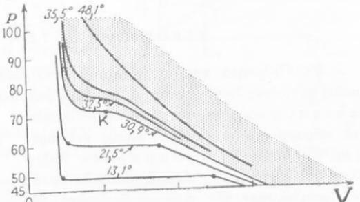
Σχ. 64. Τὸ δίκτυον τῶν ισόθερμων τοῦ διοξειδίου τοῦ ἄνθρακος. (Κρίστιμος θερμοκρασία  $30,9^{\circ}\text{C}$ , ἡ περίποια  $31^{\circ}\text{C}$ .)
