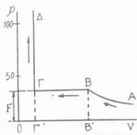
Σχ. 63. Ἰσόθερμος τοῦ  $\text{CO}_2$ , διὰ τὴν θερμοκρασίαν  $13^{\circ}\text{C}$ . (Ἡ πίεσις p εἰς at.)
