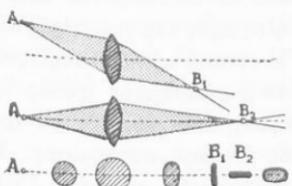
Σχ. 220. Ἀστιγματικὴ ἐκτροπή. ( $B_1$  καὶ  $B_2$  αἱ δύο ἑστιακαὶ γραμμαῖ.)
