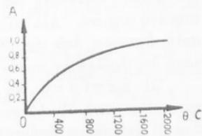
Σχ. 98. Μεταβολὴ τῆς θεωρητικῆς ἀπόδοσεως συναρτήσει τῆς θερμοκρασίας τῆς θερμῆς πηγῆς. (“Ως θερμοκρασία τῆς ψυχρᾶς πηγῆς Ἐλήφθη  $27^\circ\text{C}$ .)
