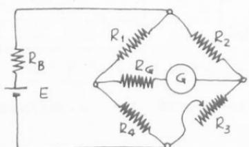
β) Εάν  $E=1,5V$ ,  $R_1=40\Omega$ ,  $R_2=100\Omega$ ,  $R_4=400\Omega$ ,  $R_G=250\Omega$  καί  $R_B$  είναι άμελητέα, νά εύρεθῃ ή τιμή της  $R_3$  διά τήν όποίαν ή γεφύρα ίσορ-
