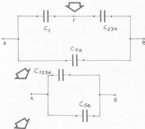
$$\text{η } C_O = \frac{\left(\frac{C_2 \cdot C_3}{C_2 + C_5} + C_4\right) C_1}{C_1 + \frac{C_2 \cdot C_5}{C_2 + C_5} + C_4} + \frac{C_5 C_6}{C_5 + C_6} \quad (5)$$
