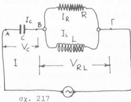
Είς το κύκλωμα του σχήματος 217 δίδονται:  $R = 15 \Omega$ ,  $C = 100 \mu F$ ,  $L = 0,1 \text{ H}$  καί  $f = 100 \text{ c/sec.}$
