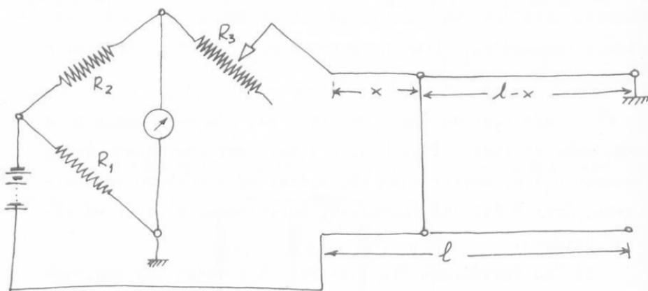
vai  $40 \Omega/\text{km}$ . Εύρατε τὴν ἀπόστασιν x τοῦ βραχυκυλώματος ἢν στὴν θέση ἴσορροπίας ἡ  $R_3$  εἶναι  $440 \Omega$ .
