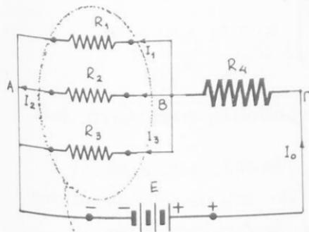
$$R = \frac{R_1 R_2 R_3}{R_1 R_2 + R_2 R_3 + R_1 R_3} = 6 \Omega$$
