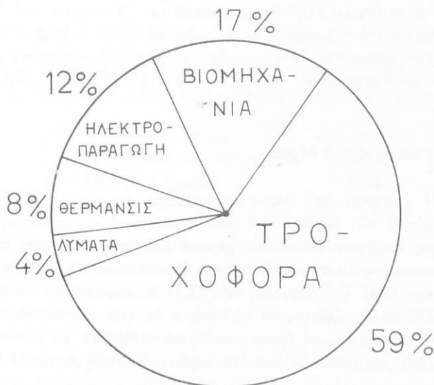
Σχήμα 17.1. Αἱ κυριότεραι πηγαὶ ἀτμοσφαιρικῆς ρυπάνσεως.
