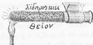
Σχ.5. Κατασκευή θειούχου σιδήρου.
