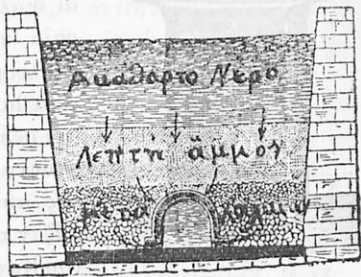
Σχ. 25. Μεγάλῃ κατασκευῇ διύλιστήριου.
