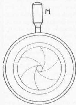
Σχ. 233. Διάφραγμα φωτογραφικής μηχανής (Τρις). Διά καταλλήλου μετακινήσεως του μοχλού M, αυξάνομεν ή ελαττούμεν το έφρος του διαφράγματος.
