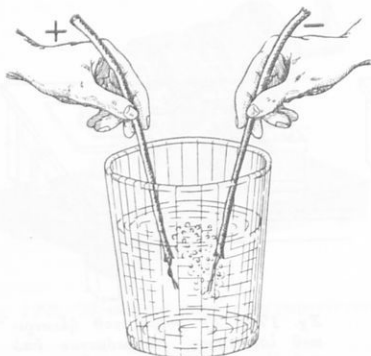
Σχ. 179. Τὸ ἡλεκτρικὸν ρεῦμα προκαλεῖ χημικὰς ἀποσυνθέσεις. (Τὰ δύο σύρματα ἔχουν συνδεθῇ με ἡλεκτρικὴν στήλην 4,5 V).
