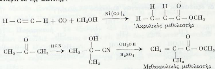
Οἱ δύο αὐτοὶ ἐστέρες πολυμερίζονται εὐκόλως καὶ χρησιμοποιοῦνται εὐρύτατα εἰς τὴν βιομηχανίαν τῶν πλαστικῶν (plexiglas κ.ἄ.).
