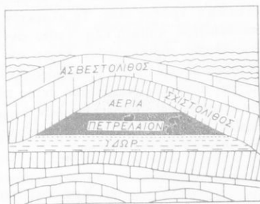
Σχ. 4. Σχηματικὴ παράστασις πετρελαιοπηγῆς
