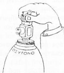
Σχ. 20.1η. Καθάρισμα στομίου του κλείστρου οξυγόνου.
