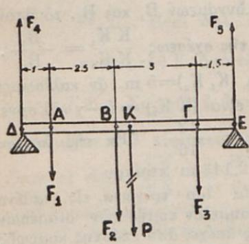
β) Διὰ τὸν ὑπολογισμόν τῆς  $F_4$ , ἀφοῦ τὸ σύστημα ἰσορροπεῖ καὶ συνεπῶς ἡ συνισταμένη τῶν δυνάμεων εἶναι μηδέν, ἀρκεῖ νὰ ἐκαρῶσωμεν ὅτι τὸ ἄθροισμα τῶν ροπῶν τῶν  $F_4, F_1, F_2, F_3$ , καὶ  $F_5$  ὡς πρὸς ἄξονα διερχόμενον διὰ τοῦ Ε εἶναι μηδέν. Παρατηροῦμεν ὅτι αἱ ροπὴ τῶν  $F_1, F_2, F_3$  εἶναι θετικαὶ, ἐνῶ τῆς  $F_4$  εἶναι ἀρνητικὴ καὶ τῆς  $F_5$  εἶναι μηδέν. Συνεπῶς θὰ εἶναι :
