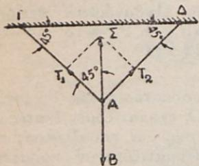
α) ἀφοῦ ἑκατέρα τῶν γωνιῶν  $\Gamma$  καὶ  $\Delta$  εἶναι  $45^\circ$ , ἡ γωνία  $A$  εἶναι ὀρθή καὶ β) ἀφοῦ ἡ γων  $T_1 A \Sigma = 45^\circ$ , ἐπειδὴ ἔχει τὰς πλευρὰς τῆς καθέτους πρὸς τὰς πλευρὰς τῆς γωνίας  $\Delta$ , τὸ τρίγωνον  $A T_1 \Sigma$  εἶναι ὀρθογώνιον ἰσοσκελές. Συνεπῶς θὰ εἶναι  $T_1 = T_2 = \chi$ . Ἀλλὰ κατὰ τὸ Πυθαγόρειον θεώρημα εἶναι  $T_1^2 + T_2^2 = \Sigma^2$  ἢ  $\chi^2 + \chi^2 = 1000^2$  ἢ  $2\chi^2 = 1000000$  ἢ  $\chi^2 =$
