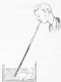
Σχ. 88. Ἡ ἀτμοσφαιρική πίεσις ἀναγκάζει τὸ νερό νὰ ἀνέλθῃ μέσα στὸν σωλήνα.
