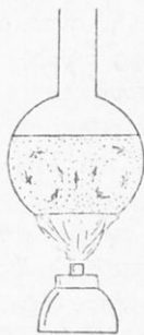
Σχ. 31. Τὸ νερὸ θερμαίνεται, ἐπειδὴ σχηματίζονται ρεύματα.
