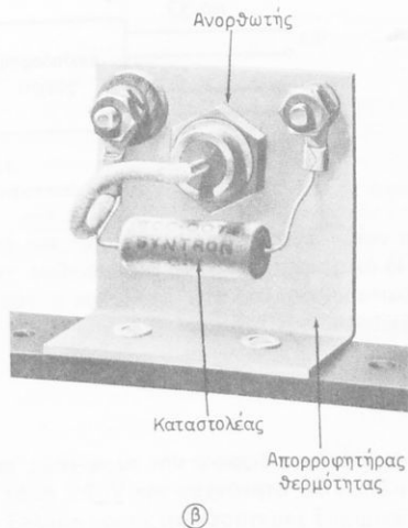
Σχ. 5.8α. Βασικό στοιχείο ανορθωτή σεληνίου.
