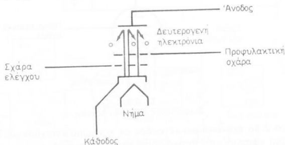
Σχ. 2.3ε. Φαινόμενο δευτερογενούς εκπομπής ηλεκτρονίων.
