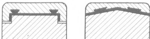
Σχ. 11.6γ. Έκκεντρο άτμομηχανής.
