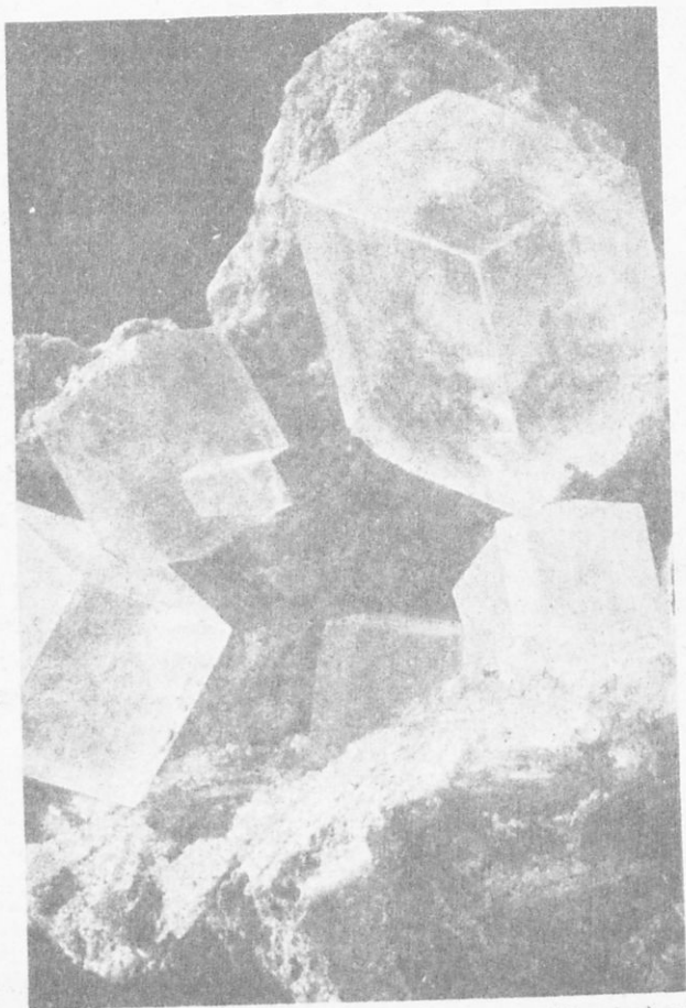
Σχ. 2. Κρύσταλλοι χλωριούχου νατρίου, σχήματος κύβου ὑπὸ μεγέθυνσιν.
