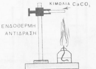
Σχ. 4 Η διάσπαση της κιμωλίας ( \text{CaCO}_3 ) με θέρμανση είναι ΕΝΔΟΘΕΡΜΗ ΑΝΤΙΔΡΑΣΗ
