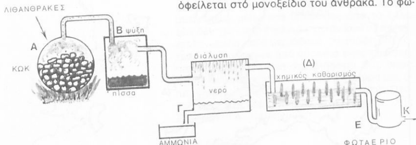
Σχ. 4 Σχεδιάγραμμα Ξερής απόσταξης λιθανθράκων
