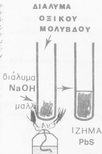
Σχ. 11 Ανίχνευση ΘΕΙΟΥ στα μαλλιά. (-α-) Κατεργασία μαλλιού με δ. NaOH (-β-). Προσθήκη οξέικου μολύβδου και βρασμός
