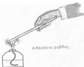
Πείραμα 1ο: Θερμαίνω σιδερένιο συρμα στη μιά άκρη του. Ή θερμότητα μεταδίδεται στο χέρι μου.
