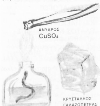
Σχ. 7 Η γαλαζοπέτρα με πύρωση δίωχνει τό κρυσταλλικό της νερό και άσπριζει
