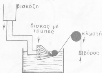
Σχ. 5 Άπλή σχηματική παράσταση τής κατασκευής τεχνητής μετάξας άπό βισκόζη. 'Η βισκόζη είναι πυκνόρρευστο υγρό που παράγεται άπό κυτταρίνη, NaOH και CS_2 (διθειάνθρακα)
