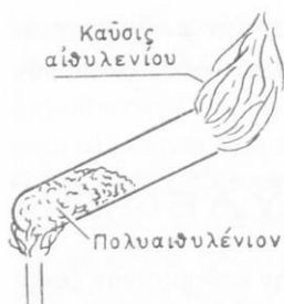
Σχ. 66. Τὸ πολυαιθυλένιον διασπᾶται καὶ παράγεται αἰθυλένιον, τὸ ὁποῖον καίεται.
