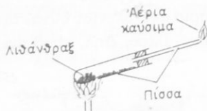
Σχ. 62. Ξηρά απόσταξις του λιθάνθρακος. Σχηματίζονται πίσσα και αέρια καύσιμα.
