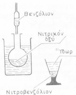
Σχ. 60. Πῶς παρασκευάζομεν τὸ νιτροβενζόλιον.
