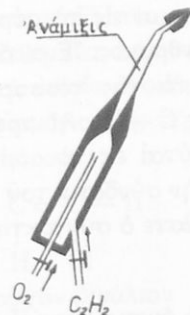
Σχ. 55. Ἡ φλόξ τοῦ ἀκετυλενίου χρησιμοποιεῖται διὰ τὴν συγκόλλησιν μετάλλων.
