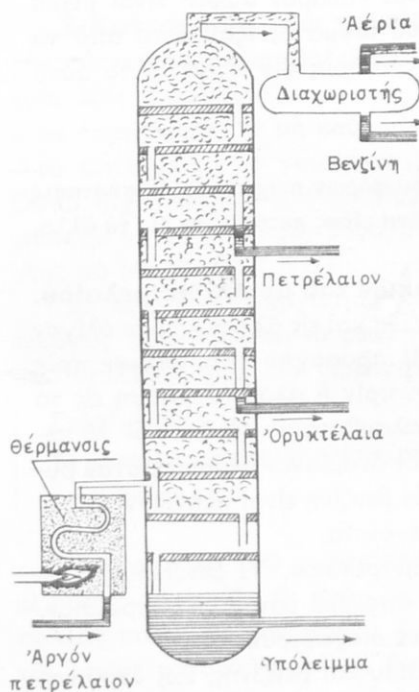
Σχ. 64. Σχηματικὴ παράστασις ἑνὸς διύλιστήριου πετρελαίου. Εἰς τὸ ἀνώτερον μέρος τῆς στήλης συλλέγονται τὰ περισσότερο πτητικὰ προϊόντα.
