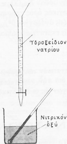
Σχ. 4. Παρασκευή νιτρικού νατρίου από την χημικήν αντίδρασιν νιτρικού όξέος και υδροξειδίου του νατρίου.
