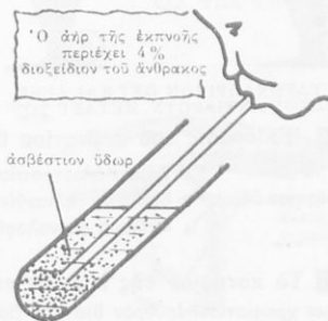
ΤΟ ΔΙΟΞΕΙΔΙΟΝ ΤΟΥ ΑΝΘΡΑΚΟΣ ΘΟΛΩΝΕΙ ΤΟ ΑΣΒΕΣΤΙΟΝ ΓΑΛΑ
