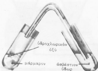
③ ΤΟ ΣΧΗΜΑΤΙΖΟΜΕΝΟΝ ΑΕΡΙΟΝ ΘΩΛΩΝΕΙ ΤΟ ΑΣΒΕΣΤΙΟΝ ΥΔΩΡ
