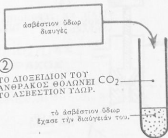
1 ΠΑΡΑΣΚΕΥΗ ΤΟΥ ΔΙΟΞΕΙΔΙΟΥ ΤΟΥ ΑΝΘΡΑΚΟΣ.
