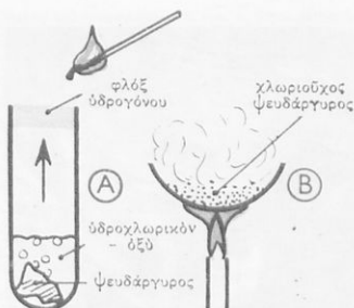
3 ΕΠΙΔΡΑΣΙΣ ΤΟΥ ΥΔΡΟΧΛΩΡΙΚΟΥ ΟΞΕΟΣ ΕΠΙ ΨΕΥΔΑΡΓΥΡΟΥ.
