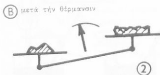
Η ΔΙΑΦΟΡΑ ΤΟΥ ΒΑΡΟΥΣ ΟΦΕΙΛΕΤΑΙ ΕΙΣ ΤΟ ΔΙΟΞΕΙΔΙΟΝ ΤΟΥ ΑΝΘΡΑΚΟΣ ΤΟ ΟΠΟΙΟΝ ΔΙΕΦΥΓΕ
