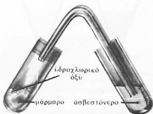
3 ΤΟ ΑΕΡΙΟ ΠΟΥ ΣΧΗΜΑΤΙΖΕΤΑΙ ΘΩΛΩΝΕΙ ΤΟ ΑΣΒΕΣΤΟΝΕΡΟ
