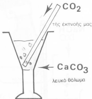
Σχ. 6 Ανίχνευση του \text{CO}_2 με διαυγές ασβεστόνερο. Σχηματίζεται λευκό θόλωμα από άνθρακικό ασβέστιο.
