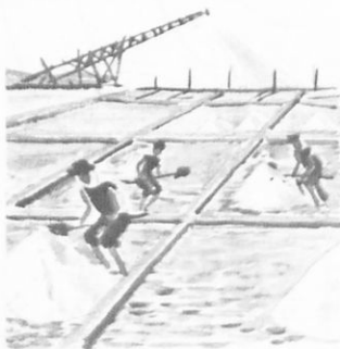
Σχ. 4 ΑΛΥΚΕΣ. Τό νερό εξατμίζεται σιγά σιγά και απομένει τό NaCl που καθαρίζεται και μετά προσφέρεται στό έμποριο σάν μαγειρικό αλάτι.
