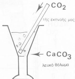
Σχ. 6 Ἀνίχνευση τοῦ \text{CO}_2 με διαυγές ἀσβεστόνερο. Σχηματίζεται λευκό θό- λωμα ἀπὸ ἀνθρακικό ἀσβέστιο.
