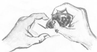
Σχ. 3 Δοκιμή γραμμής χρώματος όρυκτου σέ πλακίδιο από τραχεία πορσε-λάνη.
