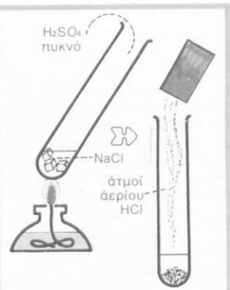
Σχ. 1. Παρασκευή HCl μέ επίδραση  $H_2SO_4$  σε NaCl.
