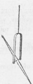
διὰ νὰ τὴν ἀναγκάσωμεν νὰ μείνῃ εἰς ὀριζόντιον ἐπίπεδον, πρέπει νὰ θέσωμεν ἔρμα εἰς τὸν νότιον πόλον της. Ἐν Ἀθήναις τὸ 1924, ὅπότε ἔγινεν ἀκριβῆς μέτρησις, δὲ βόρειος πόλος της ἡτοῦ κάτω καὶ ἐσχημάτιζε μὲ τὴν ὀριζόντιαν διεύθυνσιν γωνίαν 52° 33' 8". Ἡ γωνία, ἡ ἐποίᾳ σχηματίζεται μεταξὺ γραμμῆς ὀριζόντιας καὶ τῆς μαγνητικῆς βελόνης, ὁνομάζεται ἔγκλισις. Ἡ ἔγκλισις ἐν τῷ αὐτῷ τόπῳ δὲν είναι σταθερά· εἰς τὴν Εὐρώπην ἥδη ἐλαττοῦται ἀπὸ ἕτους εἰς ἕτος.
