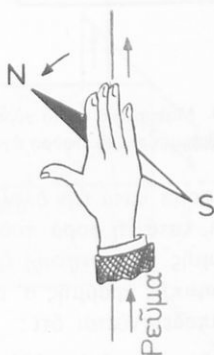
Σχ. 72. Σχέση μεταξύ τής φοράς τοῦ ρεύματος καί τής ἔκτροπής τής μαγνητικής βελόνης.
