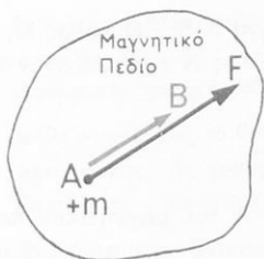
Σχ. 56. Η μαγνητική επαγωγή \vec{B} στο σημείο A του μαγνητικού πεδίου.
