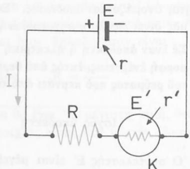
Σχ. 97. Κλειστό κύκλωμα μέ αποδέκτη (κινητήρα K).
