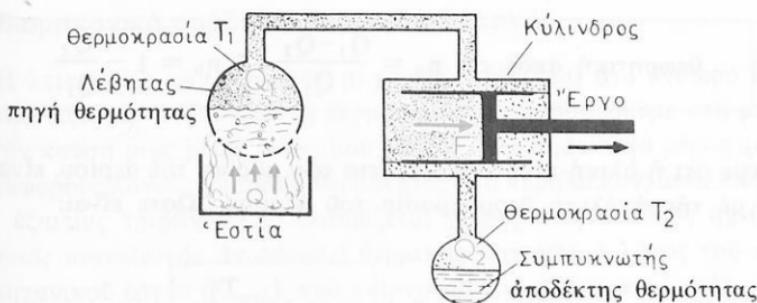
Σχ. 84. Σχηματική παράσταση ιδανικής θερμικής μηχανής.
