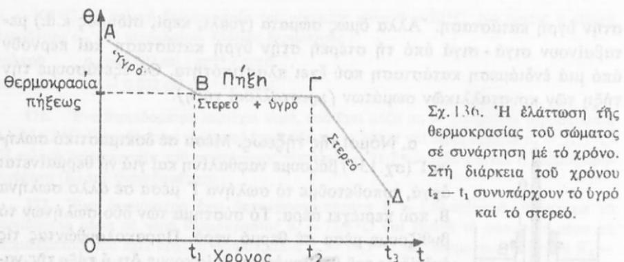
Σχ. 136. Η έλαττωση της θερμοκρασίας του σώματος σε συνάρτηση με τό χρόνο. Στή διάρκεια τού χρόνου  $t_2 - t_1$  συνυπάρχουν τό ύγρο και τό στερεό.
