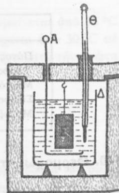
Σχ. 133. Θερμιδόμετρο μέ νερό (Θ θερμόδιμετρο. Α δργανο γιά τό άνακτεμα).
