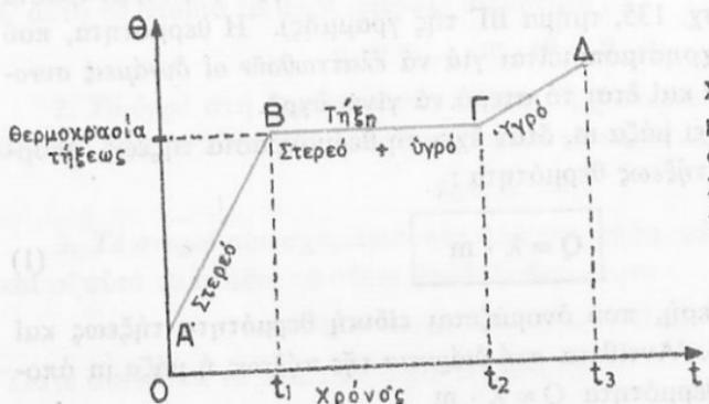
Σχ. 135. Η αδξηση τής θερμοκρασίας τού σώματος σέ συνάρτηση μέ τό χρόνο. Στή διάρκεια τού χρόνου  $t_2 - t_1$  συνυπάρχουν τό υγρό και τό στερεό.
