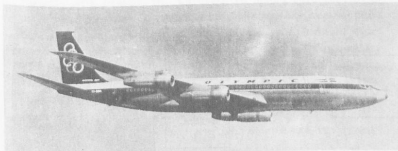
Σχ. 70. Ἀεριοθούμενον ἀεροπλάνον Μπόϊγκ 707 - 320 C μεταφορικῆς ἱκανότητος 150 ἐπιβατῶν. Ἔχει 4 μηχανάς. Προωστικὴ δύναμις ἐκάστου κινητήρος 8 150 κp. Μεγίστη ταχύτης ἄνω τῶν 1 000 km/h. Ἀκτὶς δρᾶσεως 9 600 km. Ὑψος πτήσεως 7 500 m ἕως 12 500 m.
