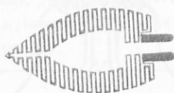
Σχ. 137. Ήλεκτρικόν σίδερο (I) και διάταξις του σύρματος θερμάνσεώς του.
