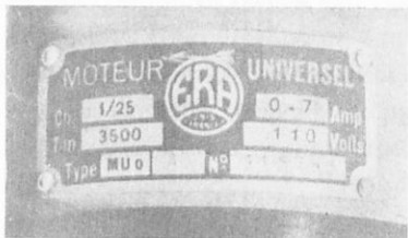
Σχ. 213 β. Ἐπιγραφή μετὰ χαρακτηριστικὰ στοιχεῖα ἑνὸς ἡλεκτροκινητήρος. (1/25 Ch, 3 500 στρ/min, 0 - 7 Ampère, 110 Volt).
