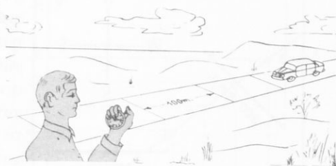
Σχ. 2. Ἡ ταχύτης ὀρίζεται ὡς πηλίκον τοῦ διαστήματος πρὸς τὸν χρόνον, ἐντὸς τοῦ ὁποῖου διηνύθη. Τὸ αὐτοκίνητον τοῦ σχήματος ἔχει ταχύτητα 100 m/sec.
