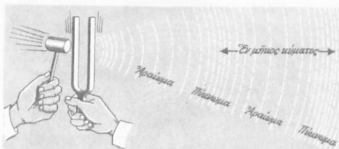
Σχ. 77. Τὸ μήκος κύματος ἐνὸς ἡχητικοῦ σώματος εἶναι ἴσον πρὸς τὴν απόστασιν δύο γειτονικῶν πυκνωμάτων (ἢ ἀραιωμάτων) τῶν μορίων τοῦ ἀέρος.
