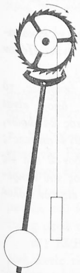
Σχ. 122. Διατήρησις τῶν αἰωρήσεων ἔκκρεμοῦς ὥρολογίου.
