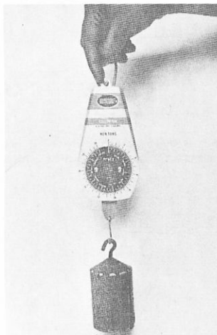
Σχ. 3. Δυναμόμετρο βαθμολογημένο σέ Newton. "Όταν τό σώμα ισορροπεί (ήρεμεί ή κινείται μέ σταθερή ταχύτητα) τό δυναμόμετρο μετράει τό βάρος του.
