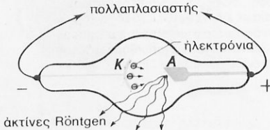
Σχ. 4. Σωλήνας παραγωγής ακτίνων Röntgen (έργαστηριακός)
