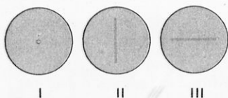
Σχ. 2. Κινήσεις της δέσμης ηλεκτρονίων για διάφορες τάσεις στα πλακίδια των πυκνωτών, όπως φαίνονται στην οθόνη του σωλήνα
