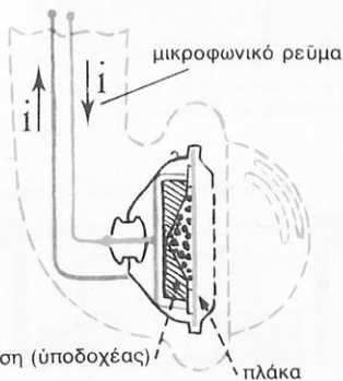
Σχ. 3. Μικρόφωνο μέ κόκκους άνθρακα
