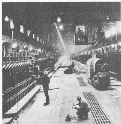
Σχ. 5. Ήλεκτρολυτικές κυψέλες για την παραγωγή καθαρού αλουμινίου (ήλεκτρόλυση τήγματος Al_2O_3 )
