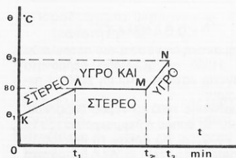
Σχ. 2. Μεταβολή της θερμοκρασίας του σώματος σε συνάρτηση με το χρόνο κατά το πείραμα της τήξεως
