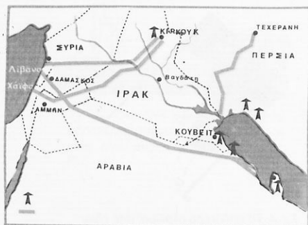
Σχ. 5. Δίκτυο πετρελαιοαγωγών στη Μέση Ανατολή. Ο «διαραβικός» πετρελαιοαγωγός ενώνει τον Περσικό Κόλπο με τη Μεσόγειο Θάλασσα και έχει μήκος 1720 Km
