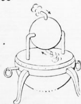
Σχ. 7. «Αἰόλου πύλαι» τοῦ Ἡρῶνος. Ὁ πρόδρομος τῶν σημερινῶν ἀεροστροβίλων
