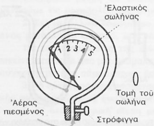
Σχ. 6: Μεταλλικό μανόμετρο
