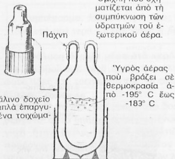
Σχ. 6: Δοχείο Dewar για τη διατήρηση υγρού αέρα.
