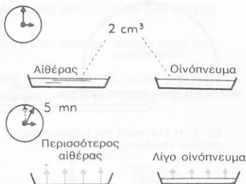
Σχ. 1: Ὁ αἰθέρας εἶναι περισσότερο πηητικός ἀπὸ τὸ οἰνόπνευμα.
