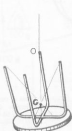
Σχ. 3. Καθορισμὸς τοῦ κέντρου βάρους ἐνὸς σκαμνίου.
