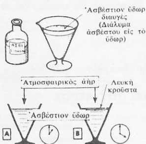
Σχ. 3. Ἡ λευκὴ κρούστα, ἡ ὁποία σχηματίζεται εἰς τὴν ἐπιφάνειαν τοῦ ἀσβεστοῦ ὕδατος, μαρτυρεῖ τὴν παρουσίαν τοῦ διοξειδίου τοῦ ἀνθράκος εἰς τὴν ἀτμοσφαιρῶν.
