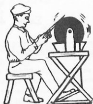
Σχ. 5. Τὸ πεντάλ (pedal) τοῦ ἀκονιστηρίου είναι μοχλός με τὴν κίνησιν ενδιαμέσως (Γ' είδους) πολλαπλασιαστής τῆς μετατοπίσεως.
