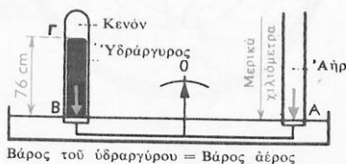
Σχ. 6. Η στήλη του υδραργύρου ισορροπεί στήλην άέρος της αύτης τομής και ύψους όσον είναι τό πάχος της άτμοσφαιρας.
