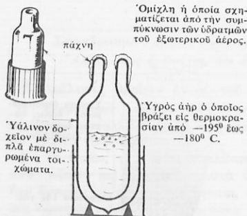
Εχ. 5. Δοχείον Dewar διά τήν διατήρησιν υγρού αέρος.
