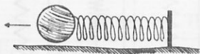
Σχ. 4. Ὄταν ἀφήσωμεν ἐλεύθερον τὸ ἐλατήριο, τὸ ὁποῖόν συνεπιέσαμεν, ἀναγκάζει τὴν σφαῖραν νὰ κινήθῃ.
