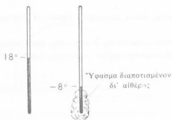
Σχ. 4. Ἡ ἐξάτμισις τοῦ αἰθέρος ψύχει τὸ θερμόμετρον.
