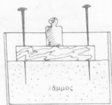
Σχ. 3. Ἡ πίεσις ἐξαρτᾶται ἀπὸ τὴν ἐπιφάνειαν ἐπαφῆς, ἐπὶ τῆς ὁποίας ἀσκεῖται ἡ δύναμις πίεσεως.
