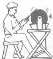
Σχ. 5. Τὸ πεντάλ (pedal) τοῦ ἀκονιστηρίου εἶναι μοχλὸς μὲ τὴν κίνησιν ἐνδιαμέσως (Γ' εἶδους) πολλαπλασιαστής τῆς μετατοπίσεως.
