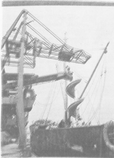
Εικ. 22.4. Φόρτωση μεταλλεύματος χύμα σέ ειδικού τύπου φορτηγό πλοίο (μπάλκ-κάριερ).
